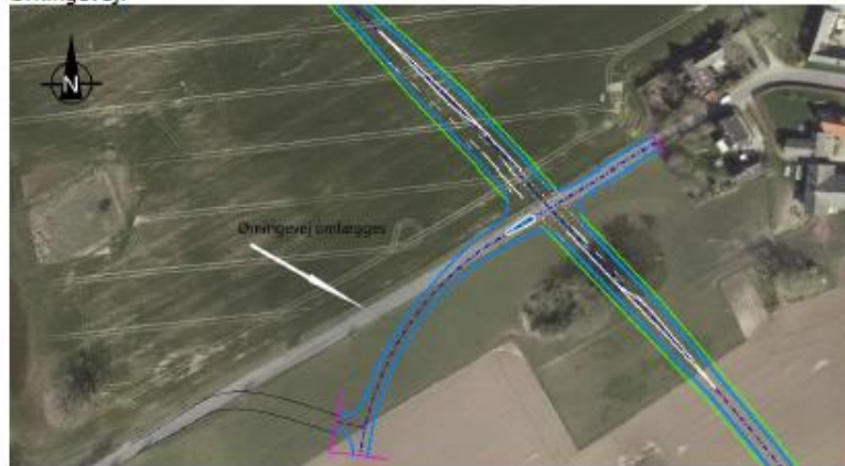
Figur 3.5 Firbenet kryds med kanalisering omfartsvej/Ørningevej
